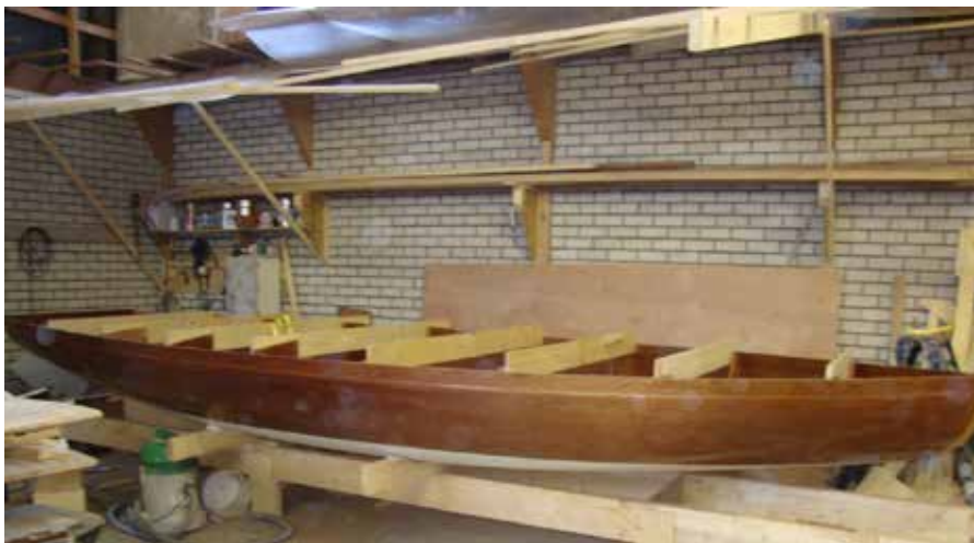
FOTO 18 & 19 & 20 Het dek maak ik van 12 mm Okumé watervast triplex dat watervast verlijmd wordt met epoxy aan de spanten.
