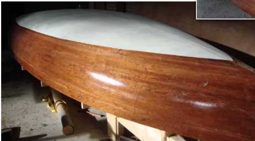
FOTO 17 Nadat de romp helemaal gelakt is en het onderwater schip in de antifouling is gezet is kan hij gedraaid worden.
