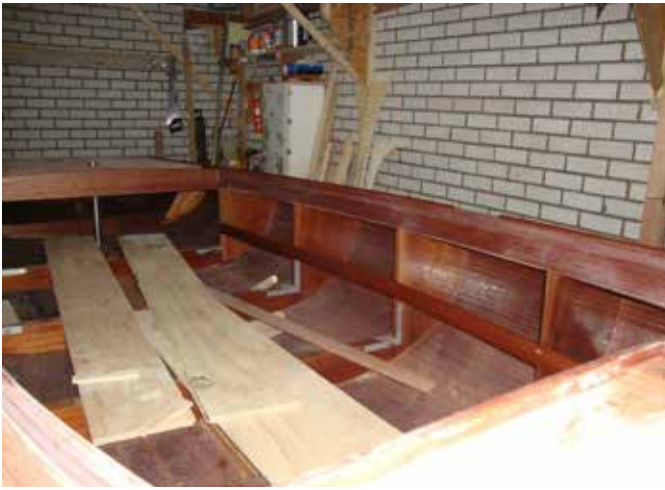
FOTO 23 - De kuipranden zijn hier al aangebracht.
