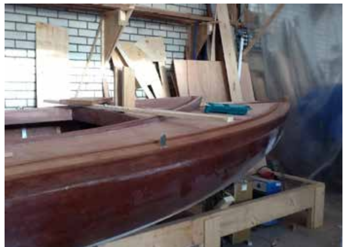
FOTO 24 & 25 - Ook de mastkoker is geplaatst. Nu kan het beslag worden aangebracht.
