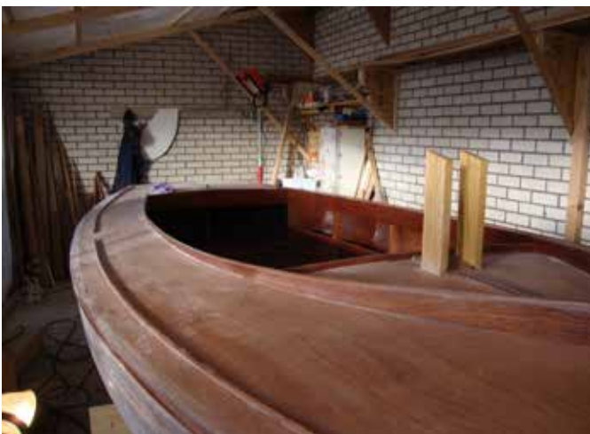
FOTO 23 - De kuipranden zijn hier al aangebracht.
