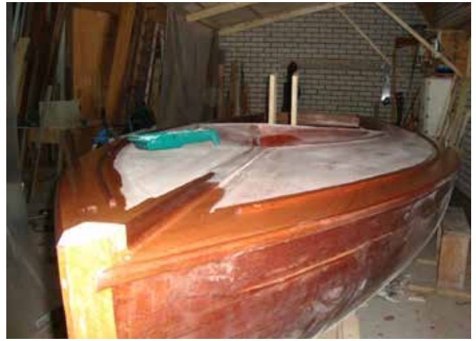
FOTO 24 & 25 - Ook de mastkoker is geplaatst. Nu kan het beslag worden aangebracht.
