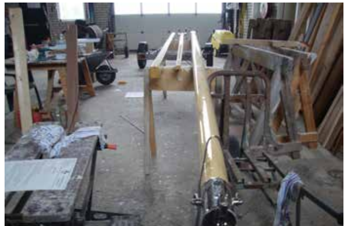
FOTO 26-27-28 - De rondhouten zijn nu klaar voor het aanbrengen van het beslag. Ook moet het beslag nu worden aangebracht op de boot. De verstagingen zijn met hulp van specialist Jan Hofstede aangebracht. Daarna is de BM-er gemeten voor registratie en heeft het nummer 4453 gekregen. Dit nummer is in de boot op de wrangen ingebeideld.
