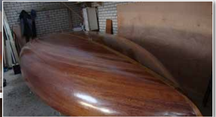
FOTO 17 Nadat de romp helemaal gelakt is en het onderwater schip in de antifouling is gezet is kan hij gedraaid worden.
